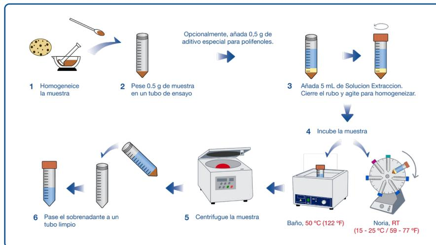
Figura 1. Esquema del procedimiento de extracción de muestras sólidas
