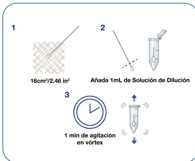
Figura 2. Esquema del procedimiento de preparación de muestra de hisopo
