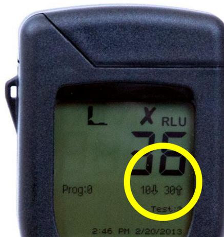
Después de ejecutar una prueba de ATP, los resultados de Pasa/Precaución/Falla se mostrarán en la pantalla del luminómetro de la siguiente manera:
